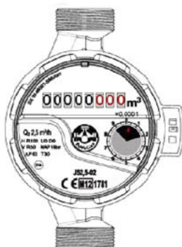
Рис. 3 Рекомендуемое положение установки счетного механизма в вертикальной системе.
