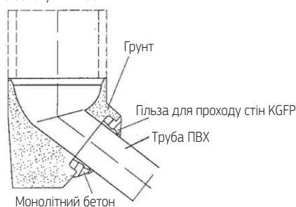
Розтруб бетонної труби (наприклад, вуличний дощоприймач)
