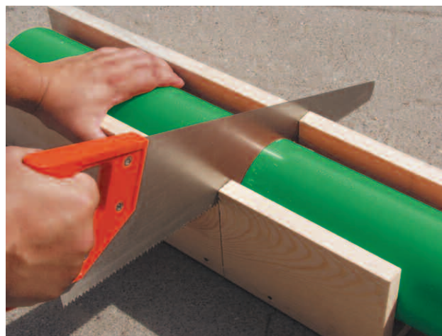
Розрізання труби з використанням столярного навскісника
