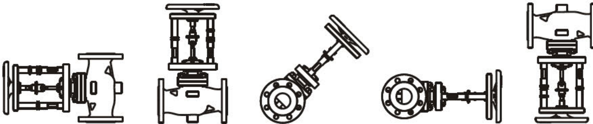
Рис. 7: Монтажные положения клапанов с ручным колесом
